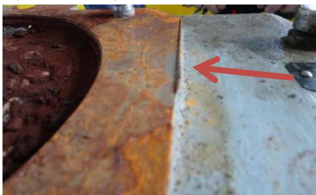
Рис 17: Облой на фланце
