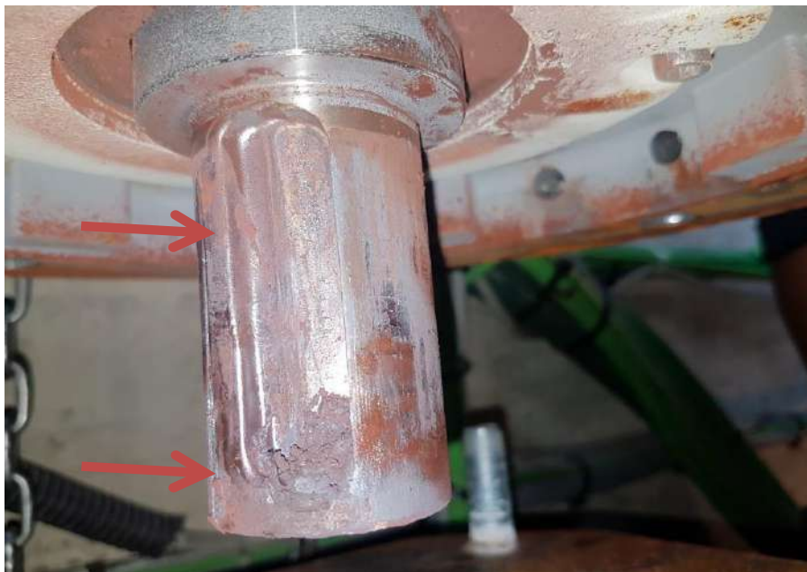
Фото 10 Повреждения на поверхности вала двигателя
