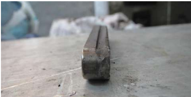
Рис 12: Повреждения / Выработка шпонки
