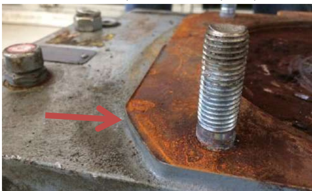
Рис 16: Облой на фланце (выступы, заусенцы)
