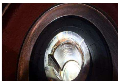
Рис 9: Очищенный впадный вал редуктора
