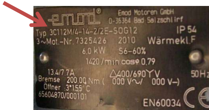
Фото 1: Табличка на приводе с индикацией типа - серия 3С или 4С (при проведении проверки делать фото данной таблички)
