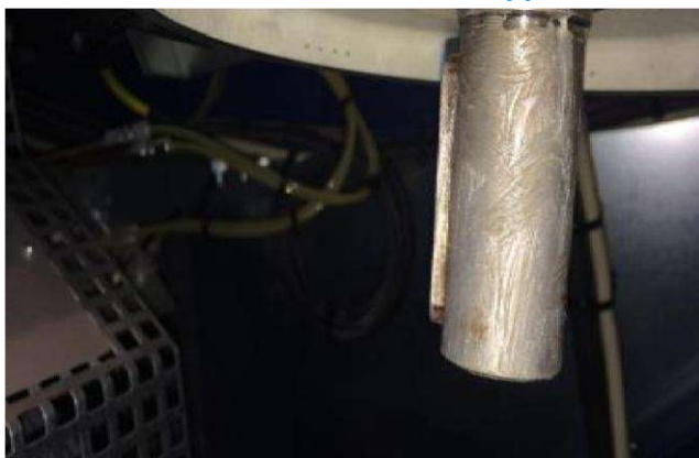
Рис 18: обработайте смазкой (Gleitmo805 или Gleitmo805K) вал двигателя
