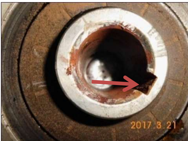
Рис 14: Скопление ржавчины в области паза вала редуктора
