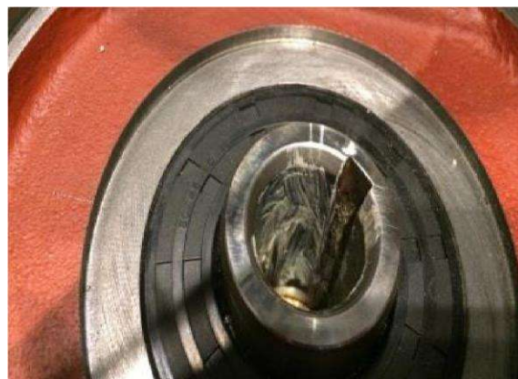
Рис 19: обработанный смазкой вал редуктора
